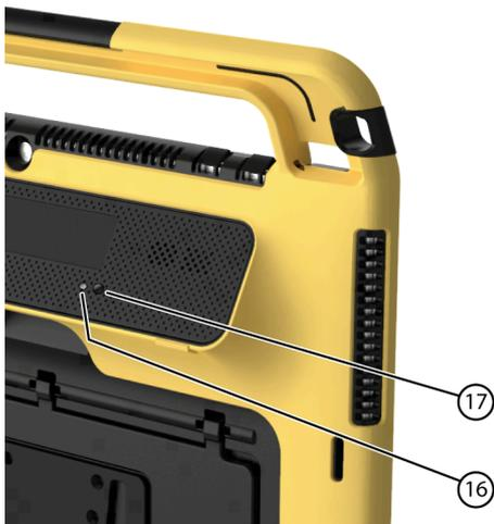
Il Vibe 12 è dotato di un ricevitore (16) e di un trasmettitore a infrarossi (17). Questo consente di controllare dispositivi come televisori, radio, lettori DVD tramite codici a infrarossi.
